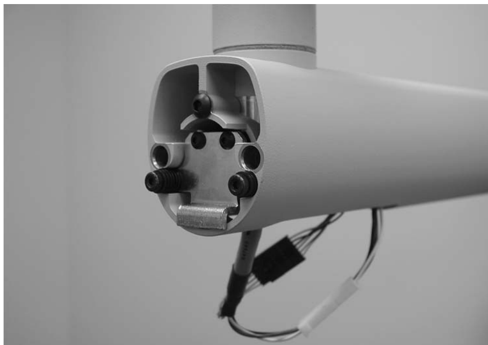
Рисунок 20 Подключение кабелей подвижного и горизонтального плеч
