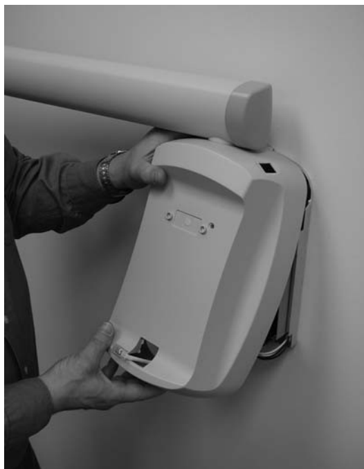
Рисунок 28 Установка передней панели на контрольный блок
