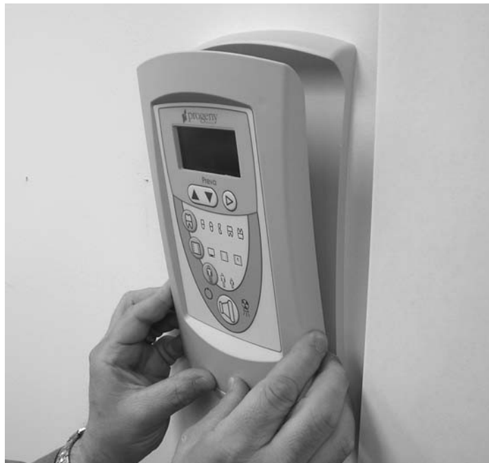
Рисунок 30 Установка панели оператора на монтажную рамку
