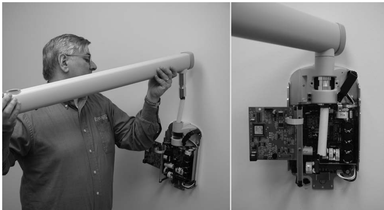
Рисунок 15 Установка горизонтального плеча
