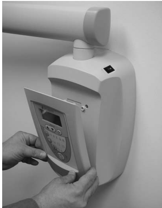
Рисунок 29 Крепление панели оператора
